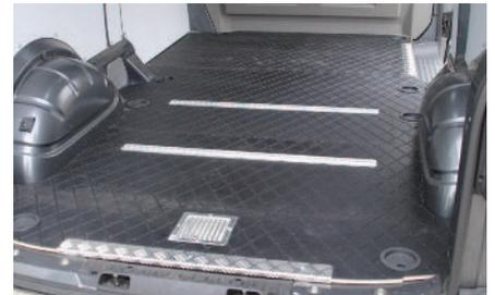
Alu Winkelschiene Quintette und Lüftungsgitter
