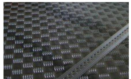
Alu Riffel Boden mit eingelegter Zurrschiene Oberflur auf Holzwerkstoff Trägerplatte
