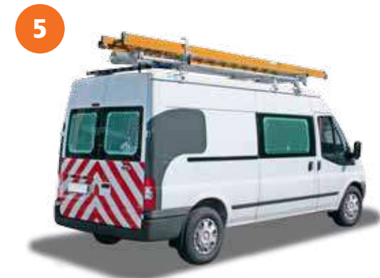
5 – Die Auto Clamp arretiert die Leiter ohne zusätzliche Zurrgurte. Bringen Sie das Vorhängeschloss als Diebstahlschutz an.
