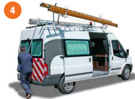
4 – Ziehen Sie am Griff, um die Leiter auf das Dach zu drehen. Gehen Sie dabei mit ausgestrecktem Arm rückwärts;
