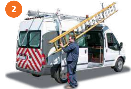
2 – Das hintere Ende der Leiter auf den hinteren Träger heben;
