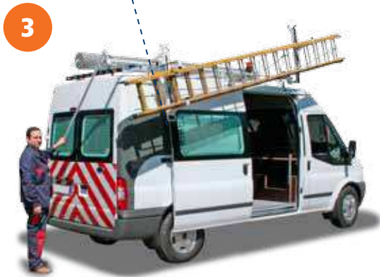
3 – Hochdachfahrzeuge: Heben Sie den Auszug nach oben, bis er fixiert ist;
