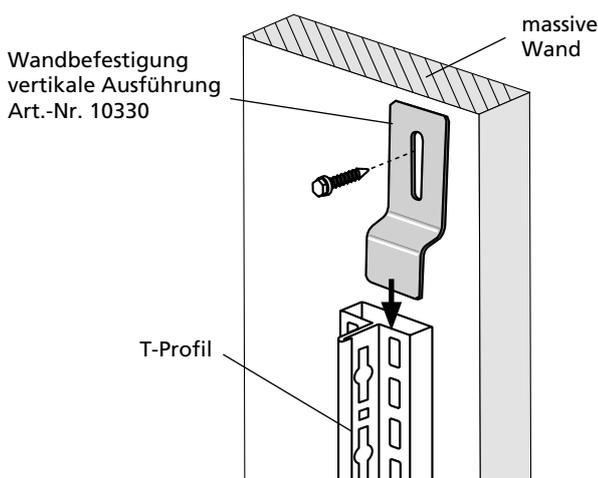
**i** Die Wandbefestigung wird mit T-Profil und Wand verschraubt.
