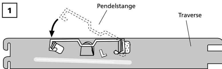
Pendelstange schräg nach oben zeigend, auf die Oberkante des Steges an der Traverse aufsetzen. Pendelstange in Pfeilrichtung nach unten drücken bis die Rundung hinter der Unterkante des vorderen Steges an der Traverse hörbar einrastet.
