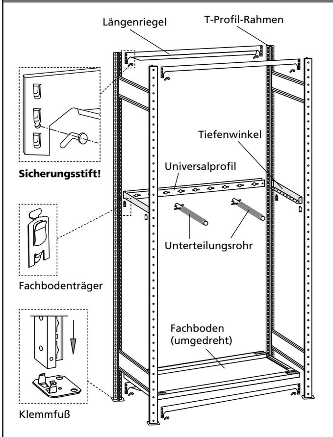
Montage Fachbodenträger und Tiefenwinkel
