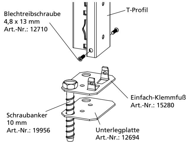
**i** Zur Bodenverdübelung verschrauben Sie den Einfach-Klemmfuß mit dem T-Profil und befestigen diese Einheit mit dem Schraubanker am Boden.
