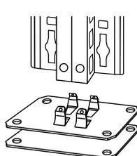
**i** Bei Abweichungen am Boden, verwenden Sie bitte Unterlegplatten für die KlemmfüÙe.
