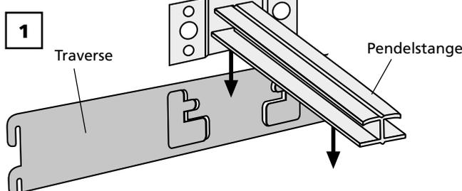
**Traversen gemäß Abb. A bis D einsetzen.**
