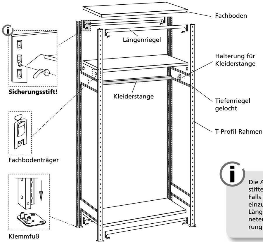
**i** Die Anbringung des Sicherungsstiftes ist zwingend erforderlich. Falls der Sicherungsstift schwer einzusetzen ist, arretieren Sie den Längenriegel mit einem geeigneten Gummihammer in die Führung bis der Sicherungsstift passt!
