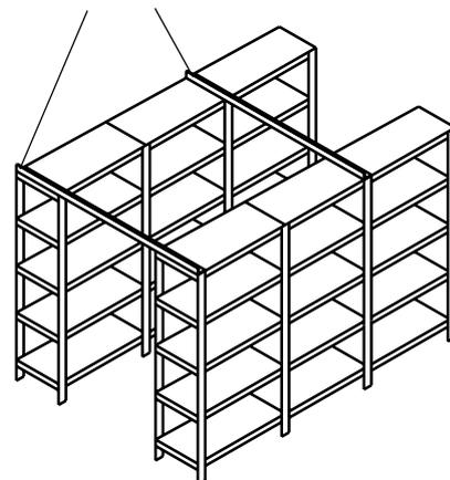
**i** Zur Verbindung und Stabilisierung von mehreren Regalzeilen werden Winkelprofile (40 x 40 mm bzw. 60 x 45 mm) benötigt.
