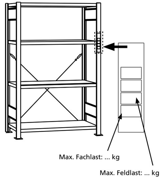
**i** Bei Regalen mit einer Fachlast von mehr als 200 kg oder einer Feldlast von mehr als 1.000 kg sind Belastungsschilder vom Betreiber auszufüllen und an gut sichtbarer Stelle anzubringen.
