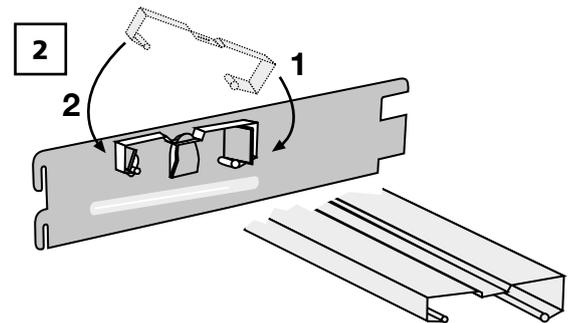
Die Pendelstange ist richtig verriegelt, wenn die Lasche an der Traverse aus dem Schlitz der Pendelstange heraustritt.
