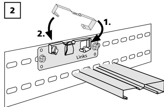
Pendelstange schräg nach oben zeigend, auf die Oberkante des Steges an der Platte aufsetzen. In Pfeilrichtung nach unten drücken bis die Rundung hinter der Unterkante des vorderen Steges an der Platte hörbar einrastet. Die Pendelstange ist richtig verriegelt, wenn die Lasche an der Platte aus dem Schlitz der Pendelstange austritt.
