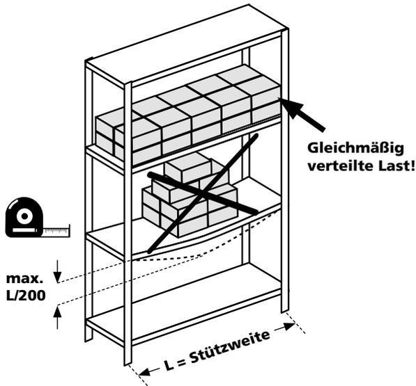
**i** Beim Beladen des Regals muss die maximale Last des Fachbodens beachtet werden. Die Fachböden müssen gleichmäßig beladen werden. Die **max. zul. Durchbiegung** der tragenden Fachböden darf nicht mehr als  $L/200$  mm der Stützweite betragen!
