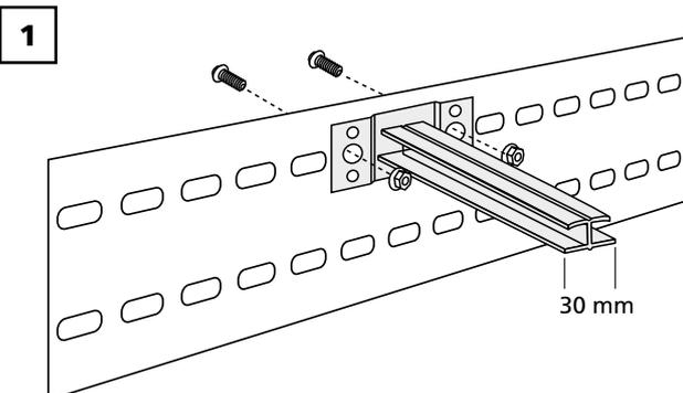
Flachbänder gemäß **Abb. A** einsetzen.
