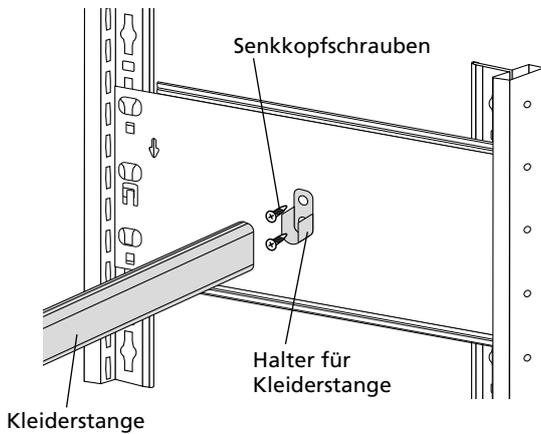
Die Halterungen mit jeweils 2 Schrauben am Tiefenriegel verschrauben und die Kleiderstange von oben einsetzen.
