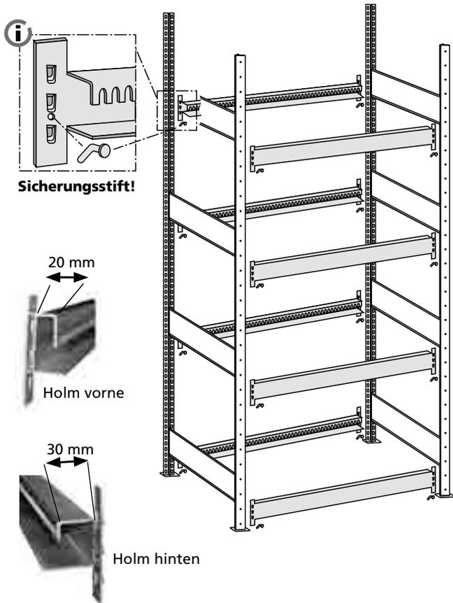
**i** Die Anbringung des Sicherungsstiftes ist zwingend erforderlich. Falls der Sicherungsstift schwer einzusetzen ist, arretieren Sie den Längsriegel mit einem geeigneten Gummihammer in die Führung bis der Sicherungsstift passt!
