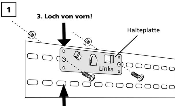
Die Halteplatte für die Pendelstange im 3. Loch von vorne einschrauben. Achten Sie auf die Beschriftung "Links" und "rechts"!
