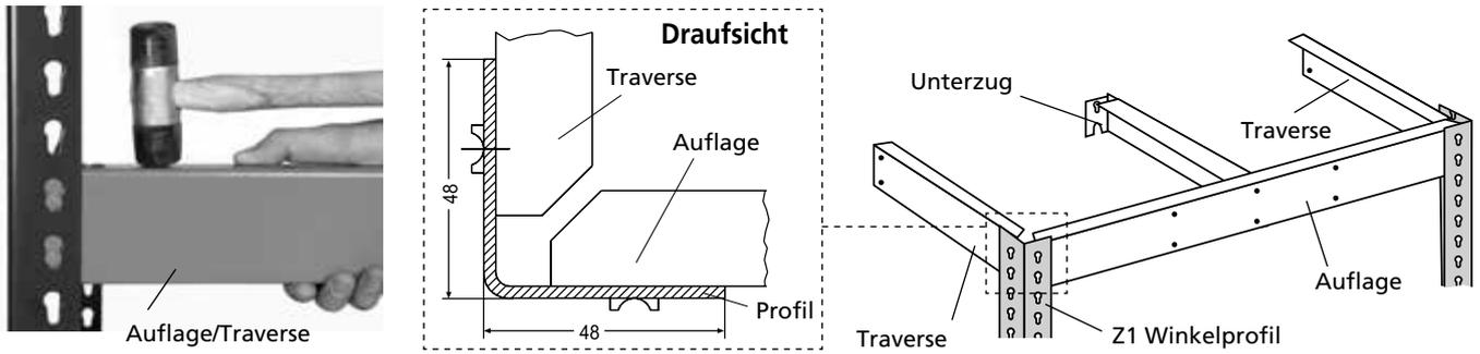
Setzen Sie die Traversen und Auflagen mit den Agraffen in die Winkelprofile ein.
