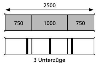
Montage & Position von Unterzügen und Stahlpaneelen
