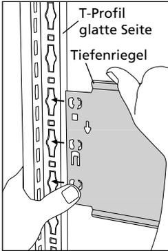
Tiefenriegel innerhalb der Aussparung möglichst weit oben ansetzen.
