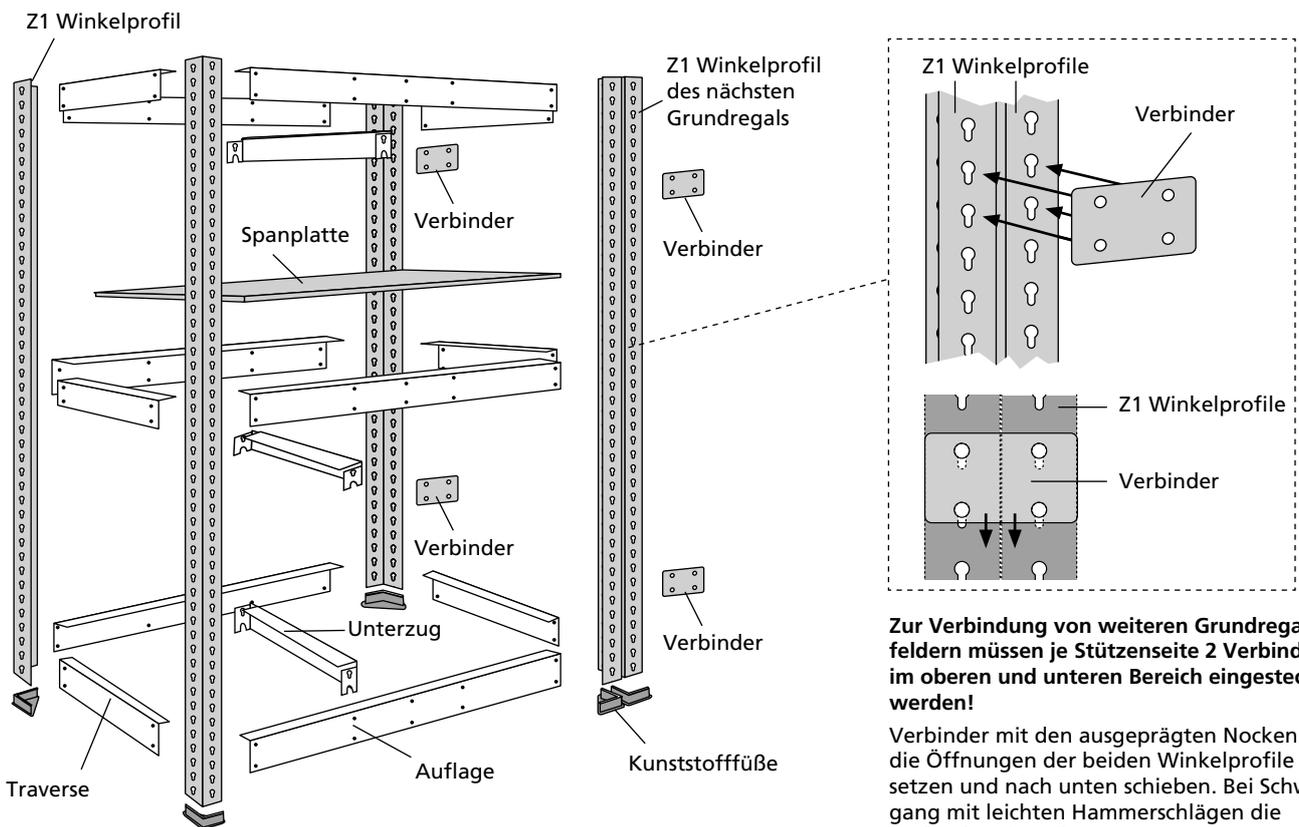
**Zur Verbindung von weiteren Grundregalfeldern müssen je Stützensseite 2 Verbinders im oberen und unteren Bereich eingesteckt werden!**
