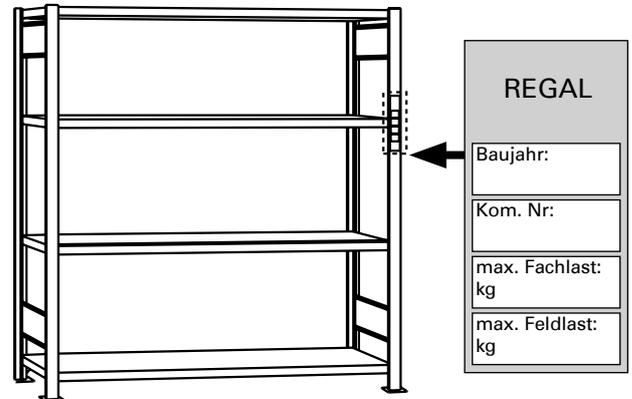
**i** Bei Regalen mit einer Fachlast von mehr als 200 kg oder einer Feldlast von mehr als 1.000 kg sind Belastungsschilder vom Betreiber auszufüllen und an gut sichtbarer Stelle anzubringen.
