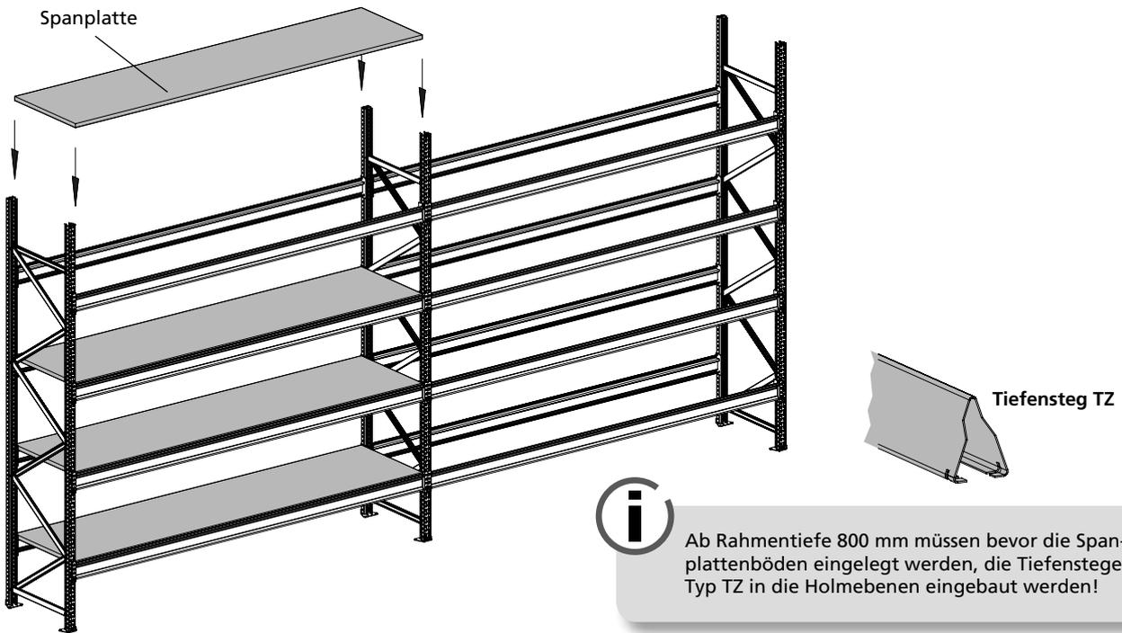
**i** Ab Rahmentiefe 800 mm müssen bevor die Spanplattenböden eingelegt werden, die Tiefenstege Typ TZ in die Holmebenen eingebaut werden!
