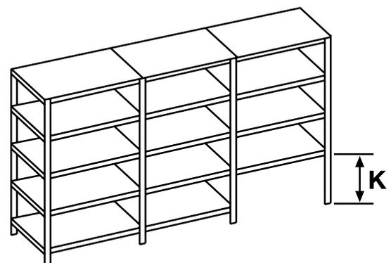
**K = WS 2000 und WS 3000:** Der erste Boden darf maximal bei 600 mm eingesetzt werden!
