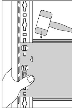
Tiefenriegel in Pfeilrichtung nach unten mit einem Gummihammer einschlagen.
