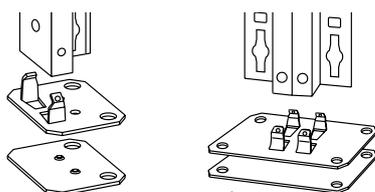
**i** Bei Bodenunebenheiten, verwenden Sie bitte **Unterlegplatten** für die RegalfüÙe.
