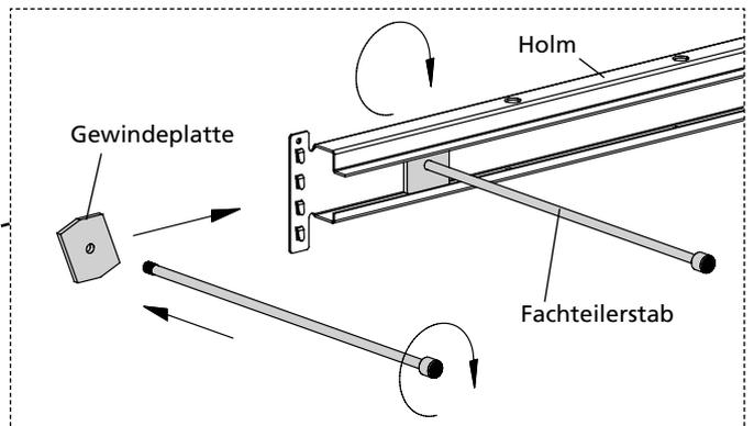
Drehen Sie den Fachteilerstab solange, bis die Gewindeplatte und der Stab fest im Holm verspannt sind.
