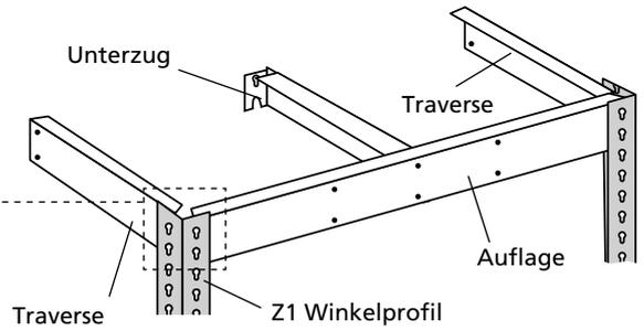
Setzen Sie die Traversen und Auflagen mit den Agraffen in die Winkelprofile ein.
