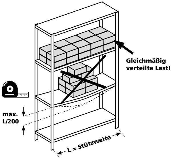
**i** Beim Beladen des Regals muss die maximale Last des Fachbodens beachtet werden. Die Fachböden müssen gleichmäßig beladen werden. Die **max. zul. Durchbiegung** der tragenden Fachböden darf nicht mehr als  $L/200$  mm der Stützweite betragen!
