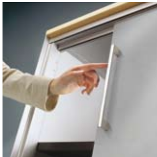
Flügel- und Schiebetüren mit Sonoperf®: Die klassischen Türausführungen sind auch im akustisch hochwirksamen Stahl-Material Sonoperf® verfügbar. Die feine, fast unsichtbare Sonoperf®-Mikrolochung weist mit Vlies-Hinterlegung selbst bei tiefen Frequenzen einen erstklassigen Absorptionsgrad auf.
