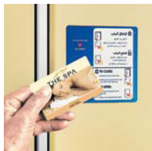
GAT-Schließsystem mit zentralem Info-Display: Während die Öffnung des Faches mit dem Datenträger direkt am Schrank erfolgt, dient das zentrale Display der Information über die Fachbelegung und die verfügbaren freien Fächer.
