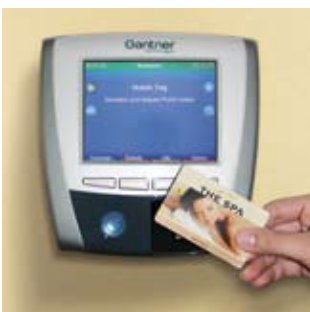
GAT-Schließsystem mit zentralem Info-Display: Während die Öffnung des Faches mit dem Datenträger direkt am Schrank erfolgt, dient das zentrale Display der Information über die Fachbelegung und die verfügbaren freien Fächer.
