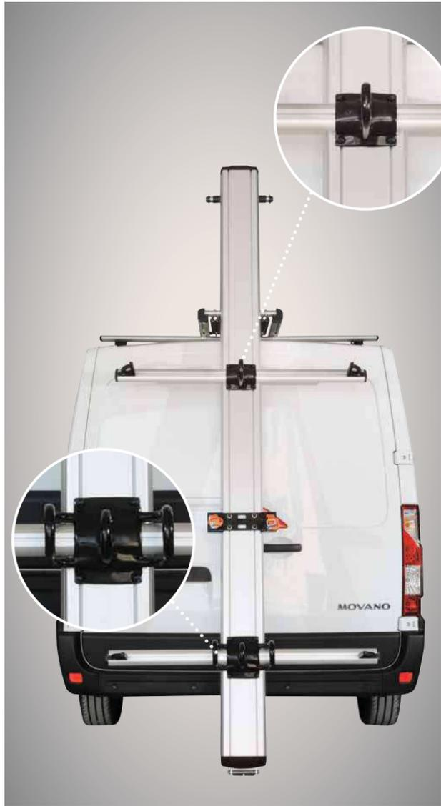
Zwei einstellbare Rückhaltebügel erlauben es 2 Leitern Seite an Seite zu laden. Eine Platte aus Stahl mit integrierten Zurr Gurten, garantieren einen sicheren Halt der Leitern während der Fahrt.
