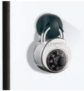
Sicherheits-Drehriegel: Ein Zerstören des Schließmechanismus durch Überdrehen ist nicht möglich, da der Schließzylinder erst mit Entfernen des Vorhangschlosses einrastet.
