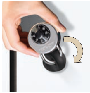
Sicherheits-Drehriegel: Ein Zerstören des Schließmechanismus durch Überdrehen ist nicht möglich, da der Schließzylinder erst mit Entfernen des Vorhangschlosses einrastet.
