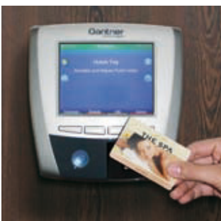
GAT-Lock 5010 mit zentralem Info-Terminal: Während die Öffnung des Faches mit dem Datenträger direkt am Schrank erfolgt, dient das zentrale Display der Information über die Fachbelegung und die verfügbaren freien Fächer.
