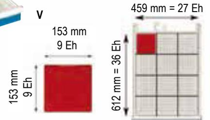
Aus Qualitätsstahlblech. Mit Einfach- und Vollauszug. Innen ringsumlaufende Schlitzungen und gelochte Schubladenböden für optimale Feinunterteilungen. Serienausführung: Alu-Etikettenleiste mit Papier- und Celluxstreifen, Griffabdeckungen.
