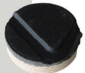
Sperrholz Birke mit grobstolligem PU-Profil, ca. 14 mm dick
