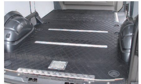
Alu Winkelschiene Quintette und Lüftungsgitter
