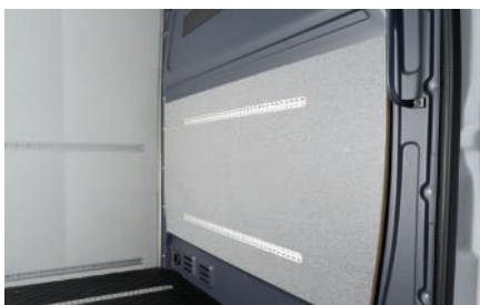
Trennwand-Prallplatte mit Zurrstreifen Unterflur
