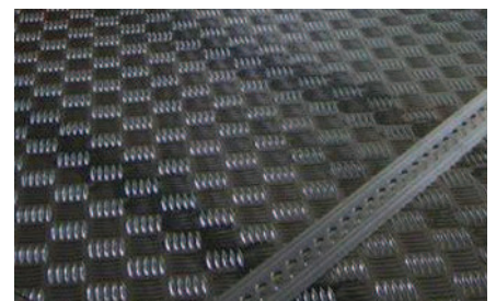
Alu Riffel Boden mit eingelegter Zurrstreife Oberflur auf Holzwerkstoff Trägerplatte
